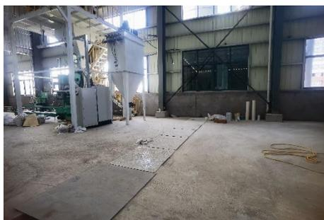
图 3-3 搅拌、打包废气处理设施照片
