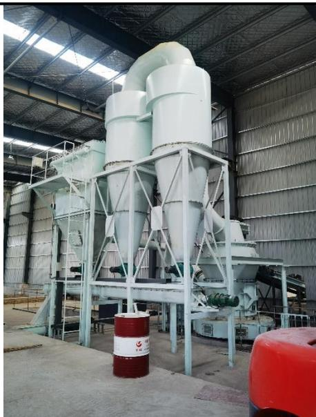
图 3-2 粉磨废气处理设施照片
