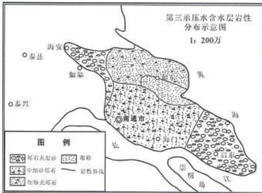
图6.2-4 第三承压水含水层岩性分布示意图
