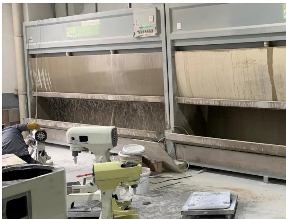
图4.1-14 刮腻子、修补、打磨废气水帘装置照片
