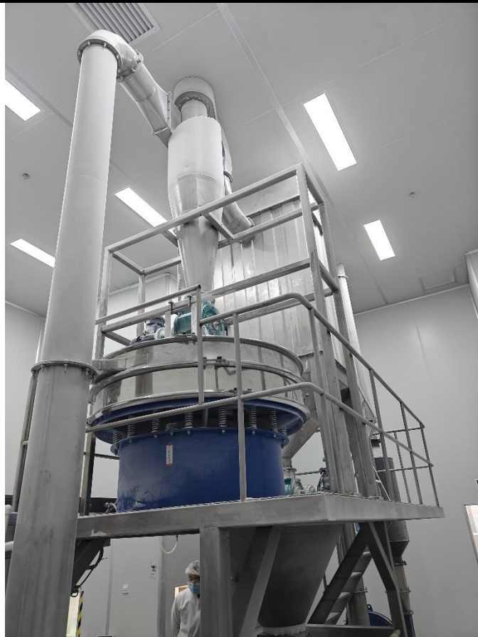
图 3-3 输送、粉碎、包装废气旋风除尘+布袋除尘装置
