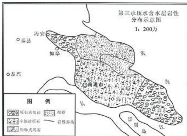
图5.2-4 第三承压水含水层岩性分布示意图
