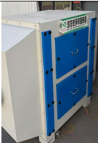
图4.1-5 危废仓库废气活性炭吸附装置
